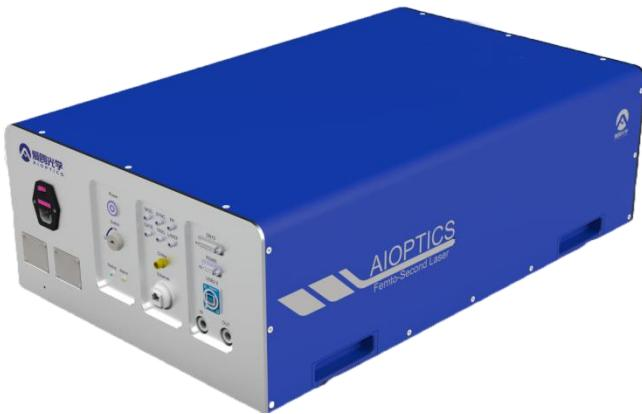
ISL-DW 系列双波长飞秒激光器是由爱鸥光学自主研发生产的，具备极高稳定性和可靠性的光纤飞秒激光器产品。本产品采用独创的智能主动稳定系统，通过对飞秒脉冲的全域智能识别以及飞秒激光器参数的全局优化控制，提供无与伦比的稳定性和抗干扰能力。整机采用一体化设计，集成1030 nm 和515 nm 两种输出波长可选，脉冲宽度小于200 fs，单脉冲能量最高可达100 μJ。结合丰富的脉冲选择和输出控制功能，本产品可广泛应用于半导体晶圆加工、光伏太阳能电池、光栅刻写、光波导芯片加工、高分子材料加工与表面处理等领域。
