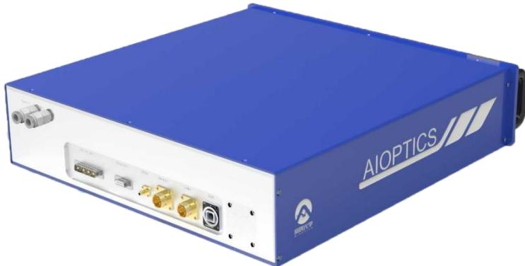
ISL-SC 系列超连续谱激光器是由爱鸥光学自主研发生产的，具备极高稳定性和可靠的光纤激光器产品。本产品采用自主设计的种子源和放大系统，提供500nm-2400nm 的输出光谱范围，输出功率大于15W，功率谱密度  $>3\text{ mW/nm}$  @500~1000nm。整机采用光电一体化结构设计，提供优秀的稳定性和可靠性。配合丰富的控制输出模式，可广泛应用于半导体检测、医疗仪器、光学相干断层扫描、机器视觉和工业检测等领域。
